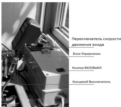
Рисунок 7. Подсистема управления ходом зонда.
