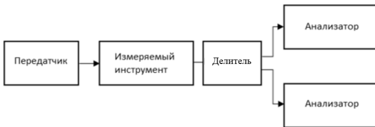
Рис. 3. Блок-схема измерительной системы методом кросс-корреляции.
