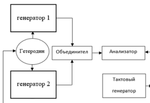
Рис. 4. Блок-схема предлагаемого метода измерения разницы в фазовых набегах сигнала между двумя передающими путями.
