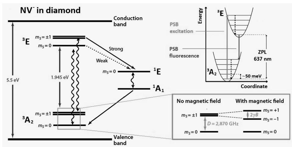
Рис. 1. Схематическое представление основных энергетических уровней и переходов NV центра в алмазе [9].
