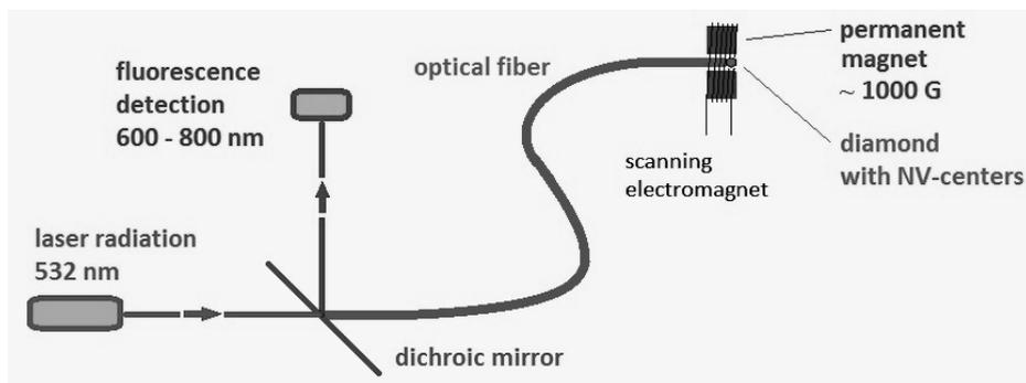
**Рис. 2. Проект схемы безмикроволнового магнитометра на основе микрокристалла алмаза с NV-центром.**
